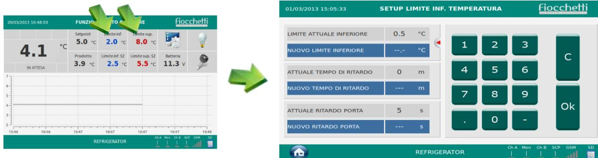
Sur la page-écran « POINT DE RÉGLAGE LIMITE INF./SUP. TEMPÉRATURE », cliquer sur « nouveau temps de retard » et composer sur le clavier la valeur que l'on souhaite régler et confirmer en appuyant sur la touche « ok ».
