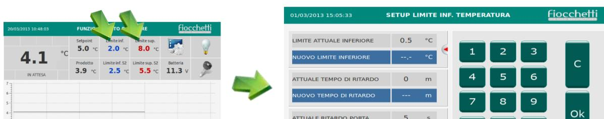
Sur la page-écran « POINT DE RÉGLAGE LIMITE INF./SUP. TEMPÉRATURE », cliquer sur « nouvelle limite inférieure » ou « nouvelle limite supérieure » et composer sur le clavier la valeur que l'on souhaite régler et confirmer en appuyant sur la touche « ok ».
