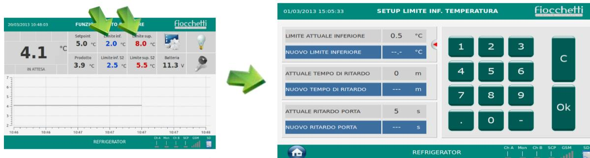
Sur la page-écran « POINT DE RÉGLAGE LIMITE INF./SUP. TEMPERATURE », cliquer sur « nouveau retard porte » et composer sur le clavier la valeur que l'on souhaite régler et confirmer en appuyant sur la touche « ok ».
