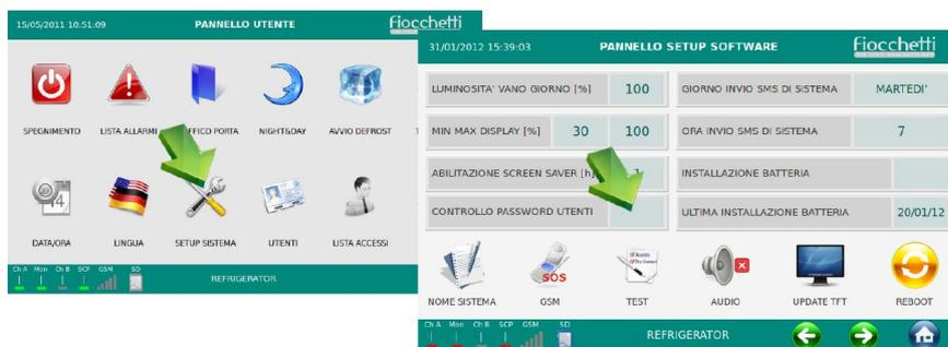
Abilitando il “controllo password utenti”
