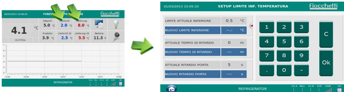
Nella schermata “SETUP LIMITE INF./SUP. TEMPERATURA”, cliccare su “nuovo limite inferiore” o “nuovo limite superiore” e digitare sulla tastiera il valore che si desidera impostare e confermare con il tasto “ok”.
