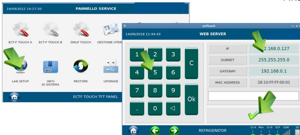
Una volta impostati i parametri di rete è possibile richiamare l'IP impostato attraverso un browser da qualsiasi PC della stessa rete (consigliato Mozilla Firefox) in modo da monitorare alcune funzioni del dispositivo. Quanto visibile in rete è indicato nella figura seguente
