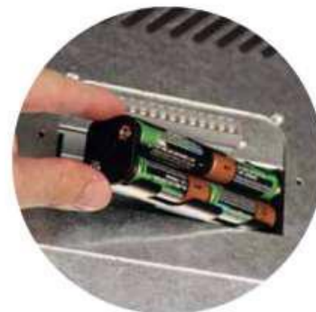
Figura 20 - Batterie a tampone
