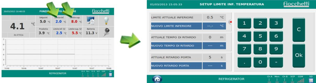
Sur la page-écran « POINT DE RÉGLAGE LIMITE INF./SUP. TEMPÉRATURE », cliquer sur « nouveau retard porte » et composer sur le clavier la valeur que l'on souhaite régler et confirmer en appuyant sur la touche « ok ».
