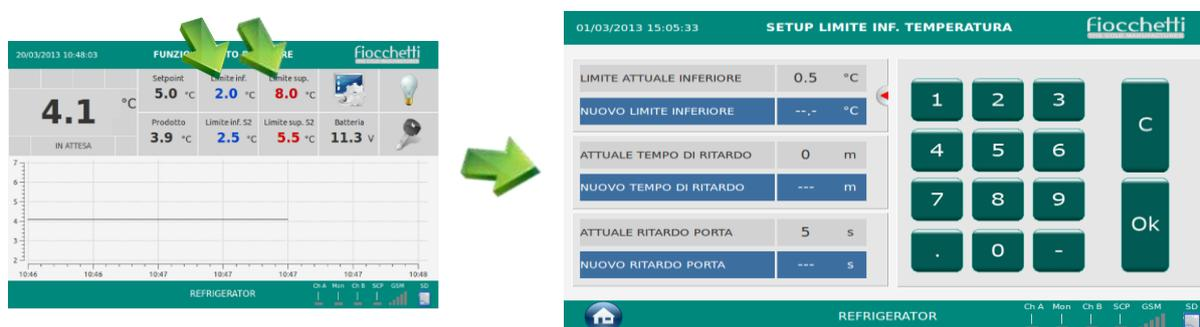
Sur la page-écran « POINT DE RÉGLAGE LIMITE INF./SUP. TEMPÉRATURE », cliquer sur « nouveau temps de retard » et composer sur le clavier la valeur que l'on souhaite régler et confirmer en appuyant sur la touche « ok ».
