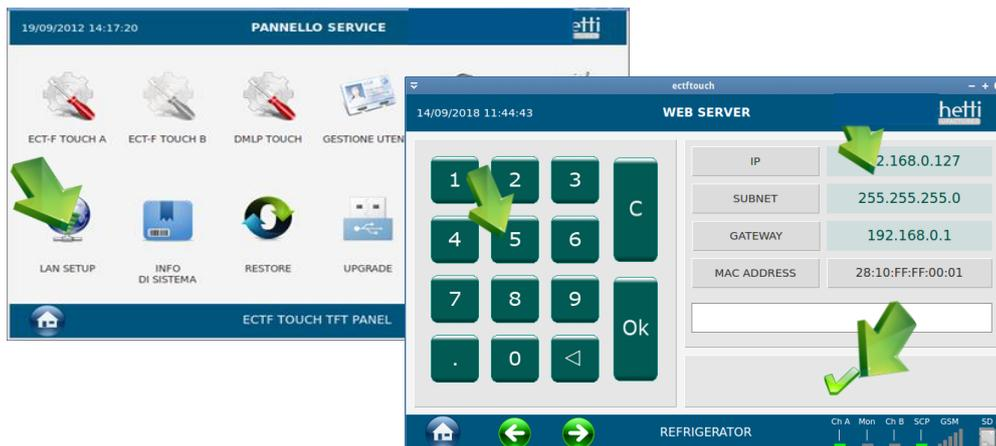
Une fois réglés les paramètres de réseau, il est possible de rappeler l'IP réglé à l'aide du navigateur de n'importe quel ordinateur du même réseau (Mozilla Firefox est conseillé) pour surveiller certaines fonctions du dispositif. Tout ce qui est visible en réseau est indiqué sur la figure suivante
