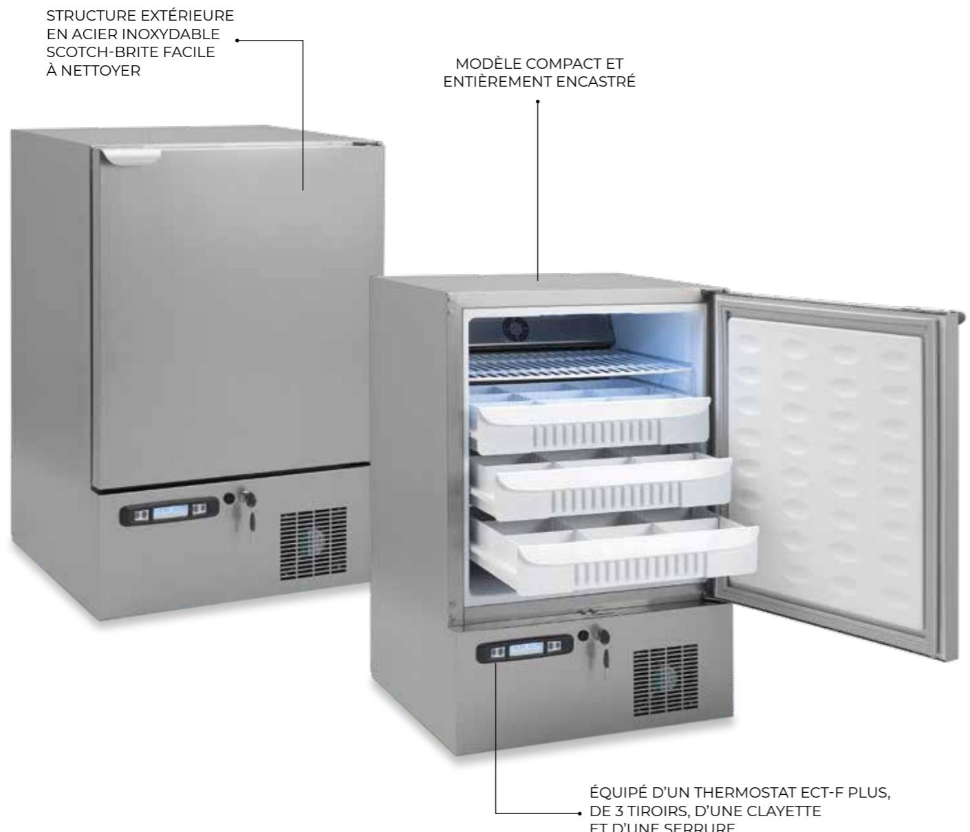
Le réfrigérateur professionnel **DOCTOR 85** combine des composants professionnels, des dispositifs de sécurité et un équipement complet sans accessoires supplémentaires : il comprend 3 tiroirs avec séparateurs, 1 étagère, une serrure à clé, un contrôleur **ECT-F PLUS DIN** avec batterie de secours pour une alarme même en cas de panne de courant, une protection antigel et des contacts propres pour le contrôle à distance des alarmes.
